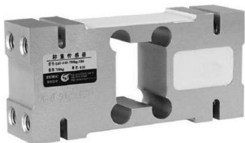
Одноточечный тип датчиков применяется для изготовления весов и весоизмерительных систем на одном датчике, в основном применяется при изготовлении торговых, напольных весов, а также дозирующего оборудования. Полимерная заливка измерительных элементов обеспечивает класс защиты тензодатчика **IP65**.
